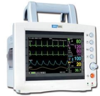
monitor BM3: SPO2 + ECG + temperatura + NIBP
