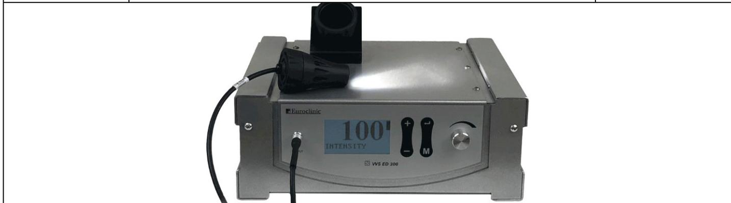
**WLS ED300** è un'apparecchiatura professionale generatrice di luce per strumenti endoscopici. Basata sull'utilizzo dei led di potenza 3 Watt al posto delle tradizionali lampade ad incandescenza. Temperatura Colore a 5.500K°/ min. 200 Lumen
